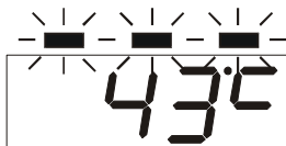
Rys. 35. Sygnalizacja pracy regulatora w trybie awaryjnym.
